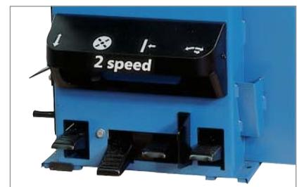
Der pedalgesteuerte Spannteller mit zwei Geschwindigkeiten macht die Reifenbearbeitung noch schneller. Das Schnellbefüllsystem für rasches und sicheres Befüllen der Reifen ist ebenfalls pedalgesteuert.
