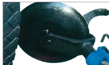
Der Abdrückteller ist mit einem speziellen Kippsystem ausgestattet, um einmal die Abdrückkraft zu erhöhen und zum anderen sicherzustellen, dass der Teller immer in optimaler Position zur Felge steht.
