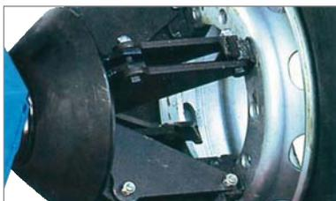
Das Spannfutter ist in Massivbauweise hergestellt, um die Bearbeitung von Rädern bis 1000 kg sicherzustellen. Ein Rückschlagventil verhindert ein Öffnen des Spannfutters im Falle eines plötzlichen Hydraulikdruckabfalls.
