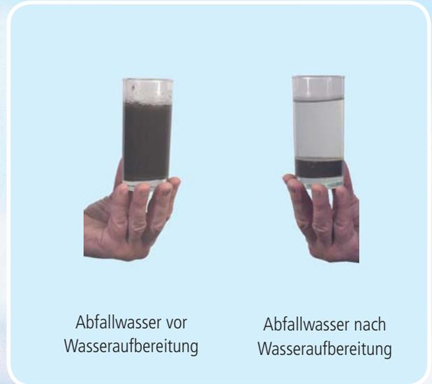
Bei Bedarf kann das **Drester Wasseraufbereitungssystem** eingesetzt werden. Nach Zugabe eines Koagulierungsmittels wird das Wasser mit einem Mixerstab umgerührt und von den Schmutzrückständen getrennt. Das so gereinigte Wasser wird in das Abwassersystem abgelassen. Die Drester Wasseraufbereitungsmethode stellt weiterhin sicher, dass alle Grenzwerte und Forderungen der Behörde eingehalten werden.
