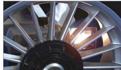
Sobald der geodata-Messarm bewegt wird, beleuchtet eine Halogenlampe die Innenseite der Felge. Der Bediener kann dadurch die Position der Klebegewichte punktgenau bestimmen und seine Arbeit über einen Spiegel verfolgen.
