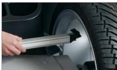
Dieser spezielle Messarm führt den Bediener zur vorgeschlagenen Position des Klebegewichts und arretiert an dieser Stelle. Das in der Klemmeinrichtung fixierte Klebegewicht kann völlig sicher platziert werden.
