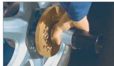
Das Rad wird mit der patentierten power clamp auf die Maschine gespannt, hierbei wird neben einem Konus vorzugsweise ein Wechselflansch (als Zubehör erhältlich) verwendet. Der Vorteil: Das Rad ist präzise aufgespannt, eine wichtige Voraussetzung für jeden Auswuchtvorgang.
