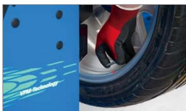
Laserpunkt für punktgenaues Platzieren von Klebegewichten am Rad. Kein Nachfordern von Gewichten, kein falsches Einsetzen. Das easyWeight garantiert erhöhten Durchsatz bei hoher Genauigkeit und gleichzeitig bequeme Handhabung: die Gewichte positionieren unten ist für den Bediener viel einfacher zu erreichen.
