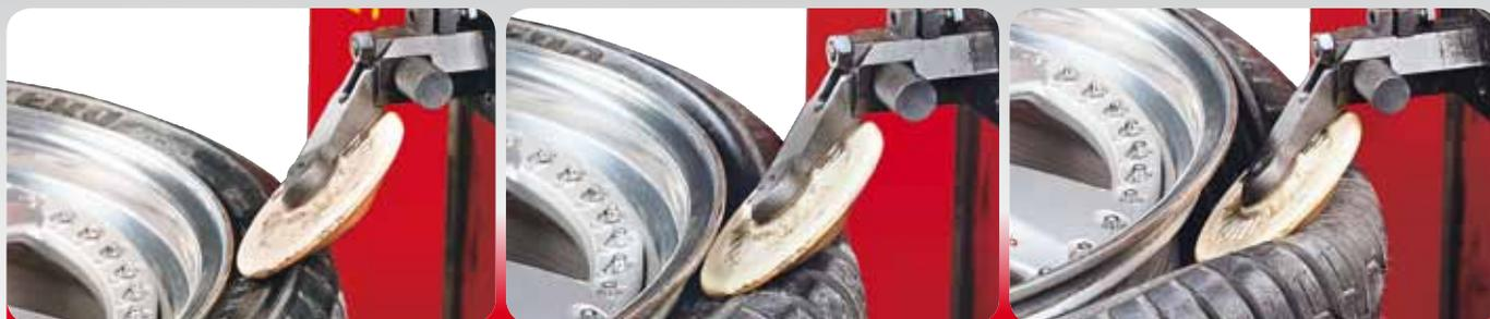
Mouvement de détalonnage à pénétration contrôlée - Abdrückbewegung mit automatischer Regelung der Eindringtiefe
