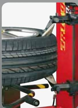
• L'utilisation simultanée des deux bras détalonneurs permet une correspondance du pneumatique sur la jante (optimisation) en réduisant les balourds en jeu et, lorsque cela est possible, le détalonnage concomitant des deux talons. (avec pneus de 6" de largeur minimum)
