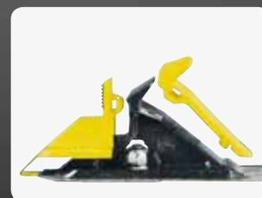
**4** Blocage pneumatique simultané du bras horizontal et de celui vertical porte-tourelle avec positionnement automatique de cette dernière dans la position idéale de travail. **4** *Gleichzeitige pneumatische Arretierung von Horizontal- und Vertikalarm mit automatischer Positionierung des Montagekopfs in der optimalen Arbeitsstellung.*
